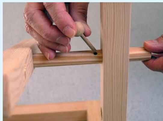
Fig. 3 : Petite goupille permettant de bloquer l'axe où est posé le plan incliné
